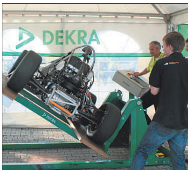
Auf dem Tilt Table werden Dichtheit und Kippgefahr des Wagens geprüft: Den Test auf dem Kipptisch konnte das Elefant Racing Team im zweiten Anlauf bestehen.
